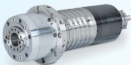
Acionamento direto com 10.000 e 12.000 rpm
