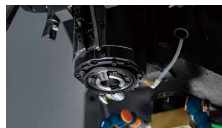
Motor síncrono (IPM) com ímã permanente embutido dentro do rotor
